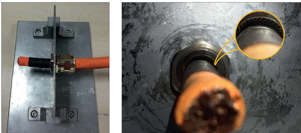
4.4. Закрутите гайку герметизирующей прокладки с необходимым усилием затяжки.
