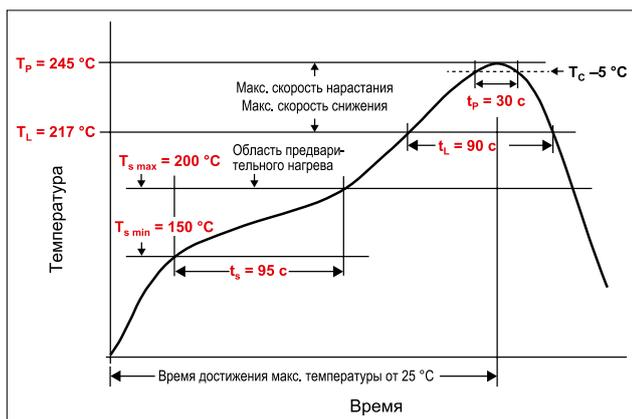
Рис. 12. Профиль плавления, используемый для элементов компании Würth Elektronik для технологии THR
