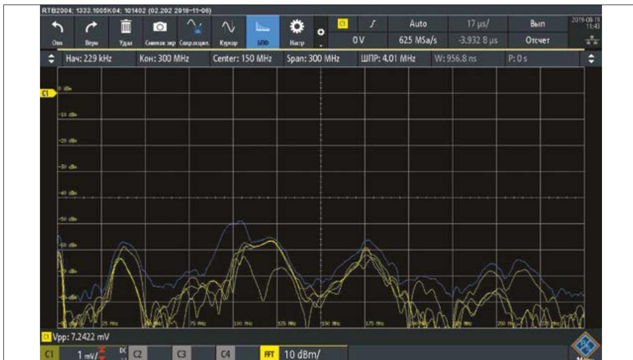
Рис. 6. Пример 3: оценочные измерения после применения рекомендаций специалиста Würth Elektronik
