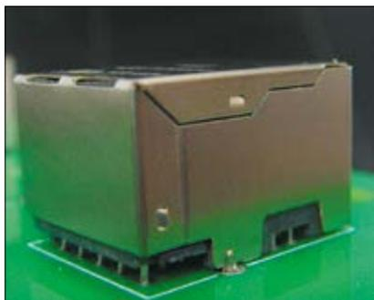
**Рис. 2. Установка разъема RJ45 для технологии THR с конструктивно обеспеченным увеличенным зазором**
