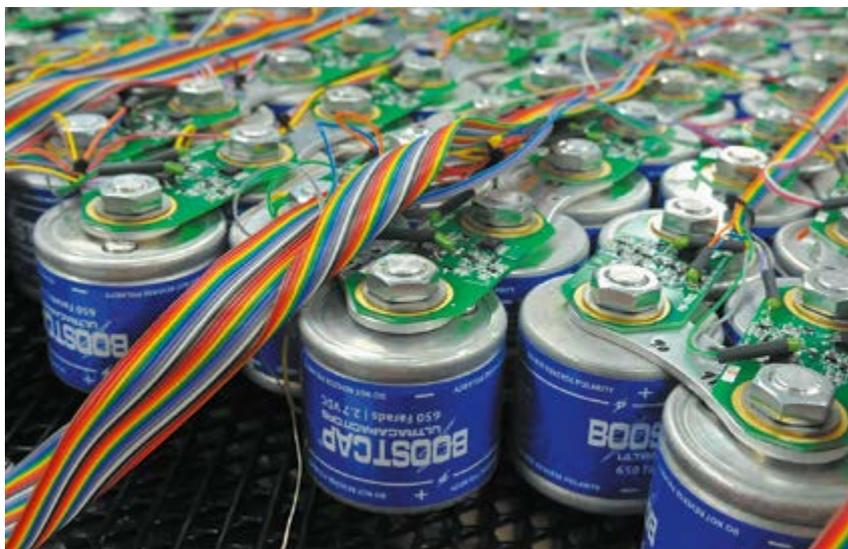
**Рис. 17.** Современные суперконденсаторы (пример: компания Tesla) могут повышать мощность или заменять батареи в транспортных средствах, быстро накапливая и отдавая энергию электрического заряда [11]
