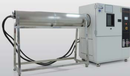
Камера для испытаний на устойчивость к воде
