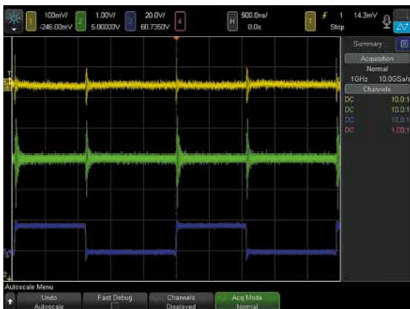
Рис. 1. Периодический случайный шум, который возникает в коммутационном узле понижающего преобразователя (сигнал синего цвета), попадает в сигнал входного напряжения (желтый цвет) и выходного напряжения (зеленый цвет)
