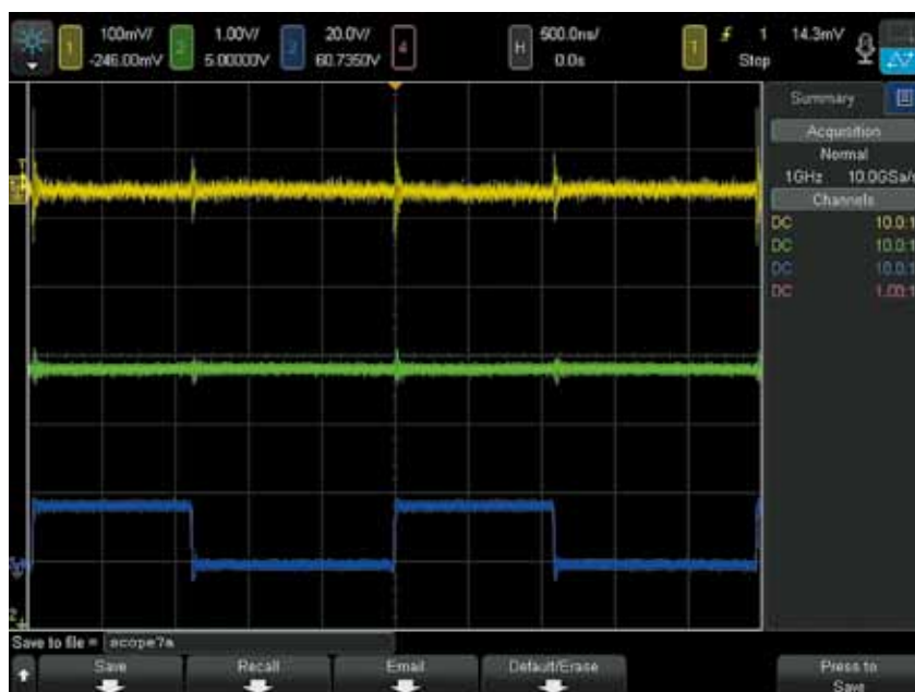
Рис. 9. Результаты тестирования ферритовых чип-бусин: шум в выходном напряжении практически отсутствует
