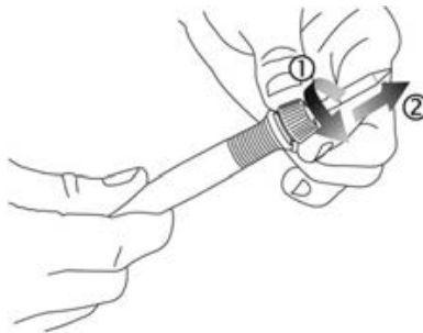
Ilust. 1: Desbloquee la punta de soldadura [1] y tire de ella [2]
