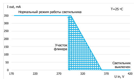
Рисунок 7 – Работа защиты от превышения входного напряжения при максимальной нагрузке и T_a = 25 \text{ }^\circ\text{C}
