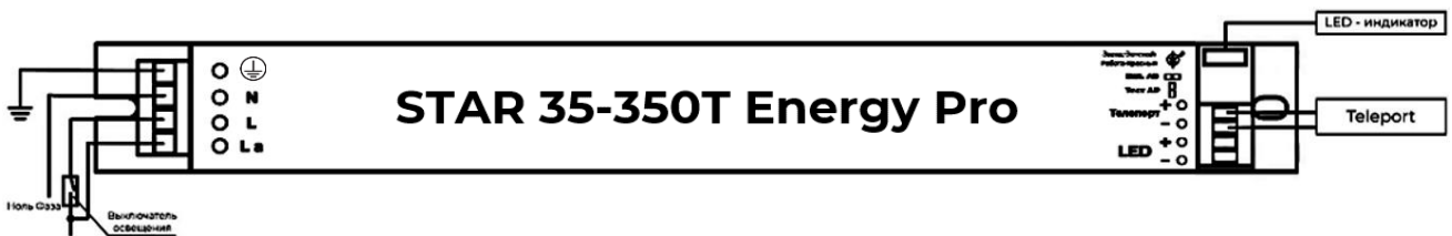
Рисунок 11 – Схема подключения УДТУ «Teleport»
