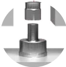
插头位移，对中误差 $D \leq 1.2\text{mm}$
