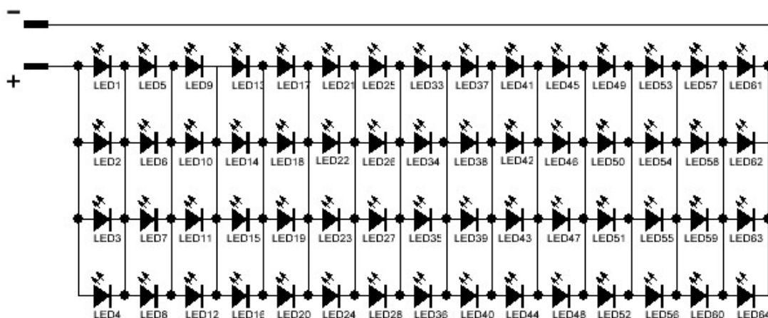
Рис. 1 Принципиальная схема светодиодного модуля ALC222.49.64-х-LM302D-XXXX
