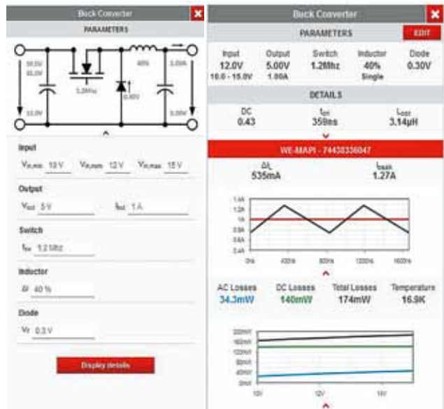
Рис. 7. Определение параметров понижающего преобразователя и потерь соответствующего дросселя
