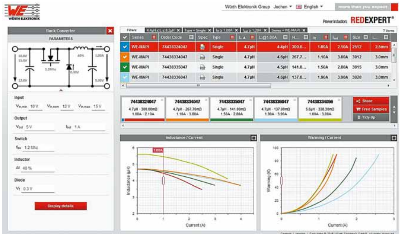
Рис. 6. Моделирование понижающего преобразователя с помощью средства REDEXPERT с использованием компонентов WE-MAPI
