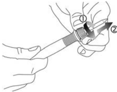
Afb. 1: Ontgrendel de soldeerstift [1] en trek hem eraf [2]
