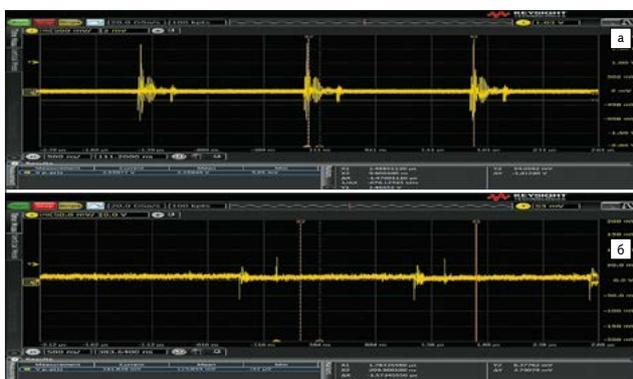
Рис. 36. Форма напряжения на выводе 9 ( $V_{cc}$ ) микросхемы контроллера повышающего преобразователя: а) базовый вариант, примерно 2,2 В (ампл.); б) улучшенный вариант, примерно 140 мВ (ампл.)
