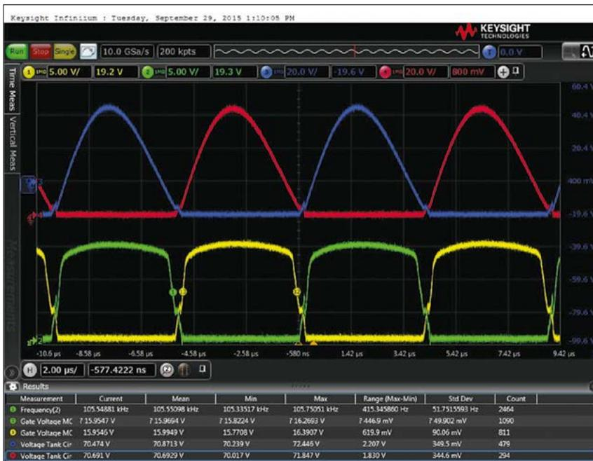
Рис. 3. Напряжения измерены на стоках транзисторов (концах катушки передатчика), показаны синим и красным цветом. Желтым и зеленым показана форма напряжения на затворах. Напряжения измерены относительно общего провода (GND) при напряжении питания  $V_{in} = 20$  В и выходной мощности  $P_{out} = 100$  Вт
