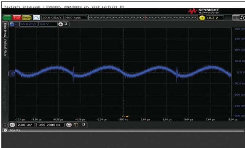
Рис. 5. Отраженные пульсации напряжения и шумы на шине питания передатчика при  $V_{in} = 20$  В и  $P_{out} = 100$  Вт
