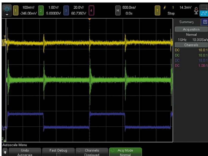
Рис. 1. Периодический случайный шум, который возникает в коммутационном узле понижающего преобразователя (синий сигнал), попадает в сигнал входного напряжения (синий сигнал) и выходного напряжения (зеленый сигнал)
