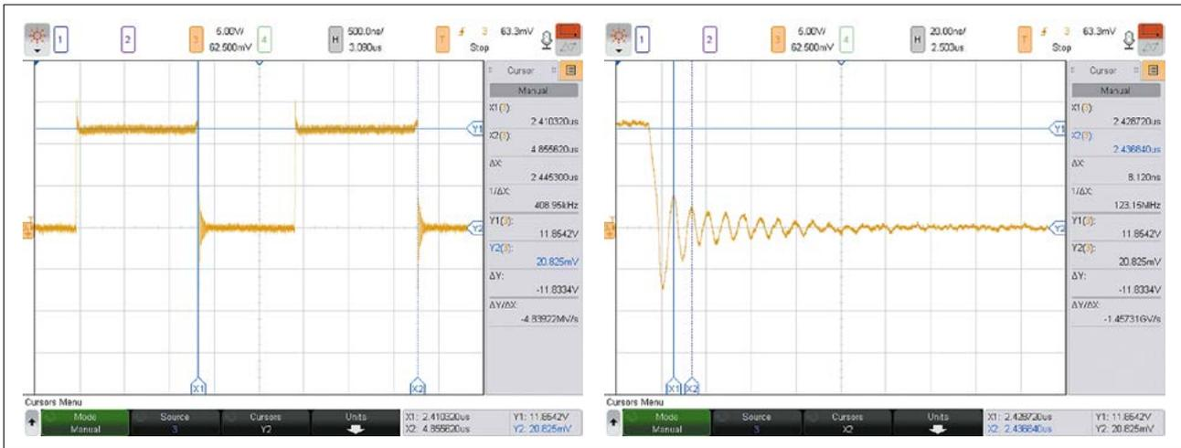
Рис. 10. Напряжение «сток-исток»  $V_{DS}$  на ключе понижающего DC/DC-преобразователя (слева) и помеха в виде звона переходного процесса во время включения ключа S1 (справа)
