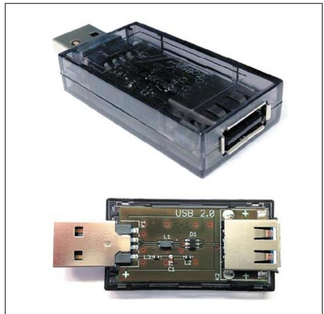
Рис. 16. USB-адаптер, выполненный по схеме, приведенной на рис. 10
