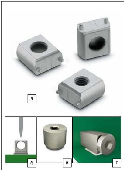
Рис. 3. Сильноточный контакт REDCUBE SMD и возможности его применения: а) внешний вид; б) автоматическая установка; в) ток до 70 А; г) соединение плат под углом 90°
