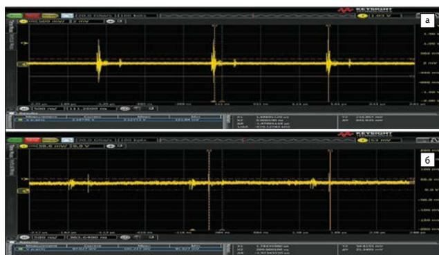
Рис. 35. Форма напряжения на выводе 10 (VIN) микросхемы контроллера повышающего преобразователя: а) базовый вариант, примерно 2,2 В (ампл. п-п); б) улучшенный вариант, примерно 90 мВ (ампл. п-п)
