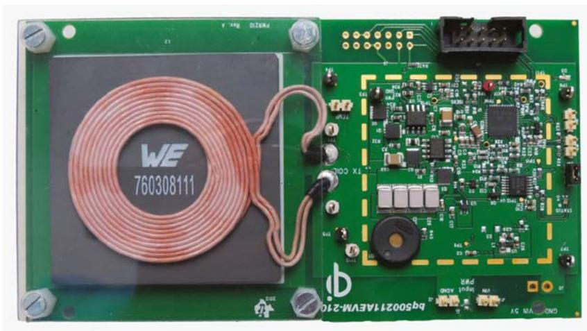
Рис. 2. Плата передатчика bq500211AEVM-210 от Texas Instruments
