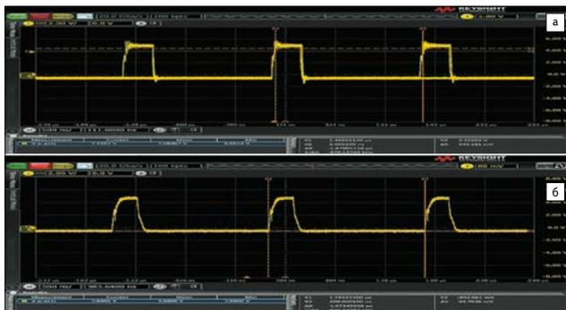
Рис. 32. Форма напряжения затвор-исток силового МОП-транзистора в схеме повышающего DC/DC-преобразователя: а) базовый вариант; б) улучшенный вариант
