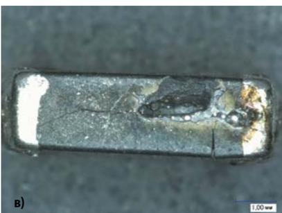
Рис. 6. Ферритовые чип-бусины, которые оплавилась и сгорели в результате перегрева после протекания больших токов
