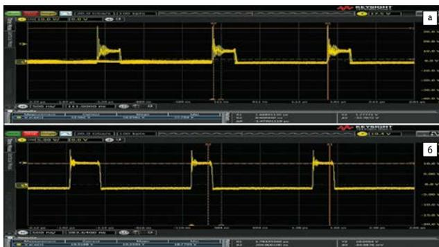
Рис. 34. Форма напряжения на диоде Шоттки: а) базовый вариант, примерно 40 В (ампл. п-п); б) улучшенный вариант, примерно 19 В (ампл. п-п)
