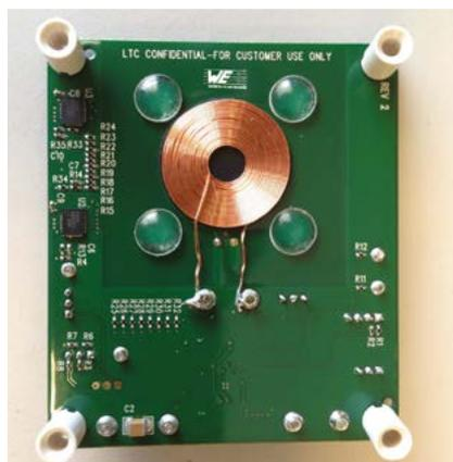
Рис. 4. Демонстрационная плата приемника DC1967A с катушкой 760308101303 от WE
