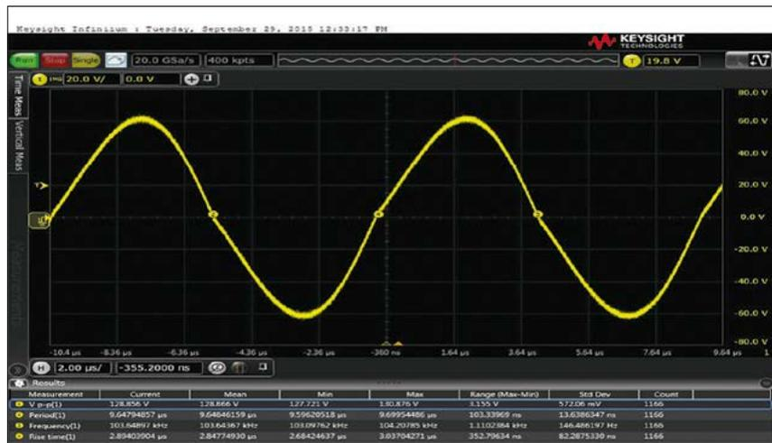
Рис. 4. Напряжение непосредственно на катушке передатчика без привязки к общему проводу GND при  $V_{in} = 20$  В и  $P_{out} = 100$  Вт
