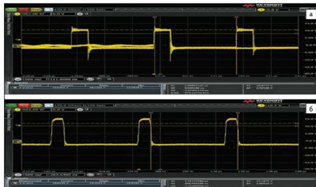
Рис. 33. Форма напряжения сток-исток силового МОП-транзистора в схеме повышающего DC/DC-преобразователя: а) базовый вариант; б) улучшенный вариант
