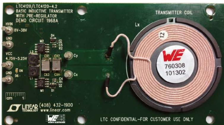
Рис. 5. Демонстрационная плата передатчика DC1968A с катушкой 760308101302 от WE
