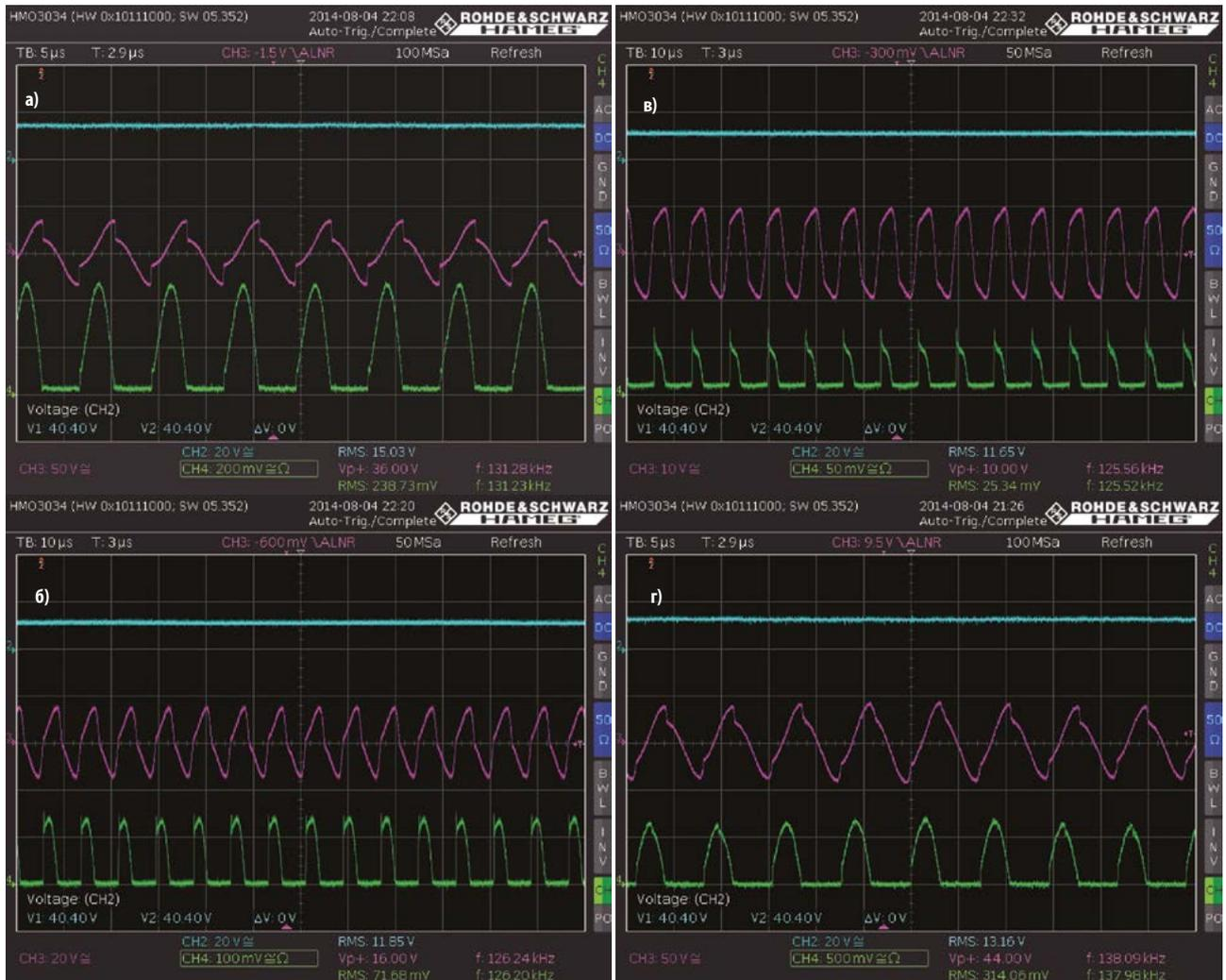
Рис. 6. Осциллограммы, описывающие разные условия испытаний: а) Вариант 1:  $T_x$  – WE# 760 308 101 302,  $L = 5,3 \text{ мкГн}$ ; б) Вариант 2:  $T_x$  – WE# 760 308 104 113,  $L = 12 \text{ мкГн}$ ; в) Вариант 3:  $T_x$  – WE# 760 308 110,  $L = 24 \text{ мкГн}$ ; г) Вариант 4:  $T_x$  – TDK# WT-505060-8K2-LT,  $L = 5 \text{ мкГн}$
