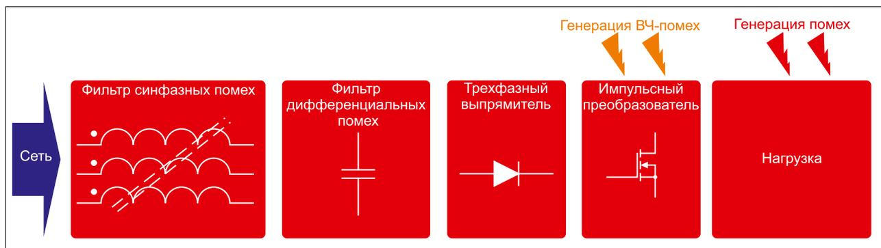
Рис. 1. Возникновение мощных помех в промышленном оборудовании
