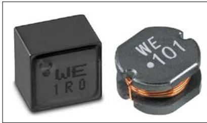
Рис. 7. Катушки индуктивности WE-LHM1 и WE-PD2 с «точкой», указывающей начало обмотки
