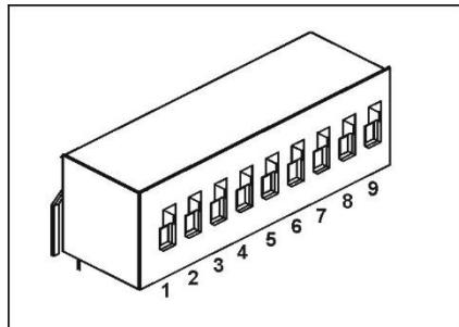
Рис.4-3: DIP-переключатель SW1
