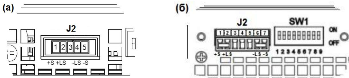
Рис.3-9: Расположение сенсорного разъема: а)-для моделей от 7,5 до 600 В; б)-для моделей от 800 до 1500 В
