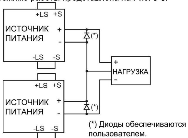
Рис.5-3: Последовательное соединение для получения положительного/отрицательного выходного напряжения
