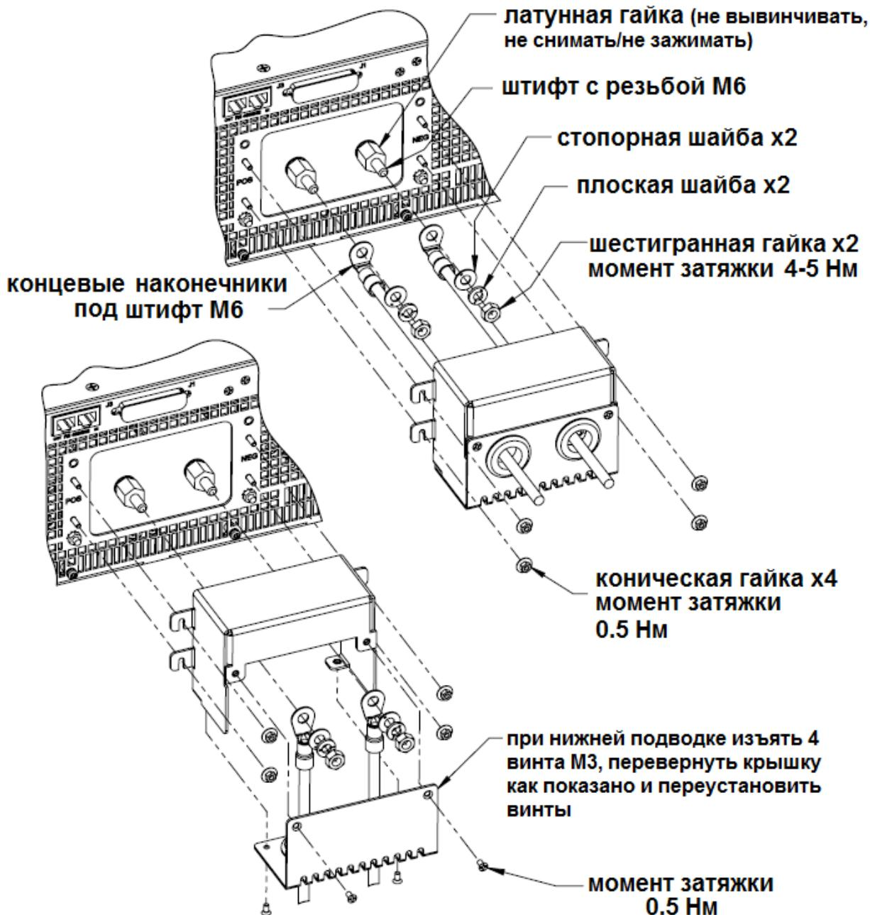
Установка кожуха при нижней подводке кабеля
