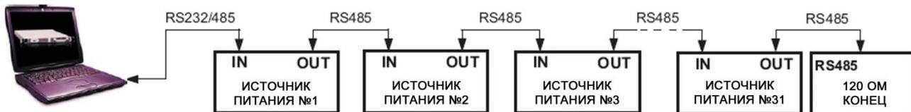
Рис. 7-5: Подсоединение нескольких источников питания через RS232/485
