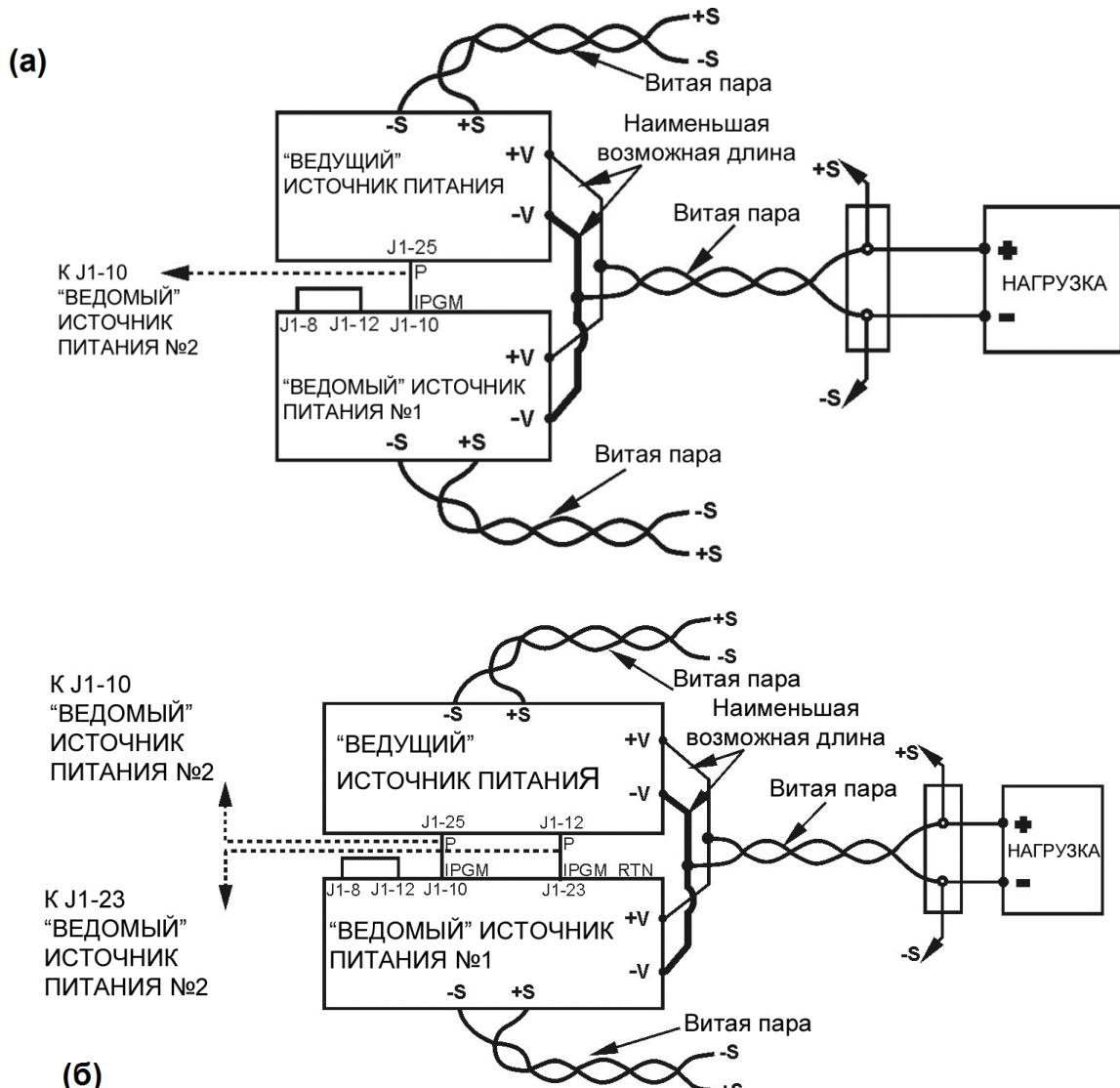
Рис.5-5: Параллельное соединение в режиме внешнего контроля: а)-для моделей от 7,5 до 600 В; б)-для моделей от 800 до 1500 В
