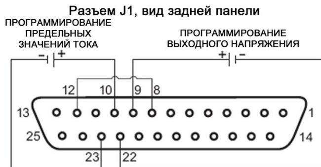
Рис.6-1: Подсоединение внешнего программирования уровнями напряжений
