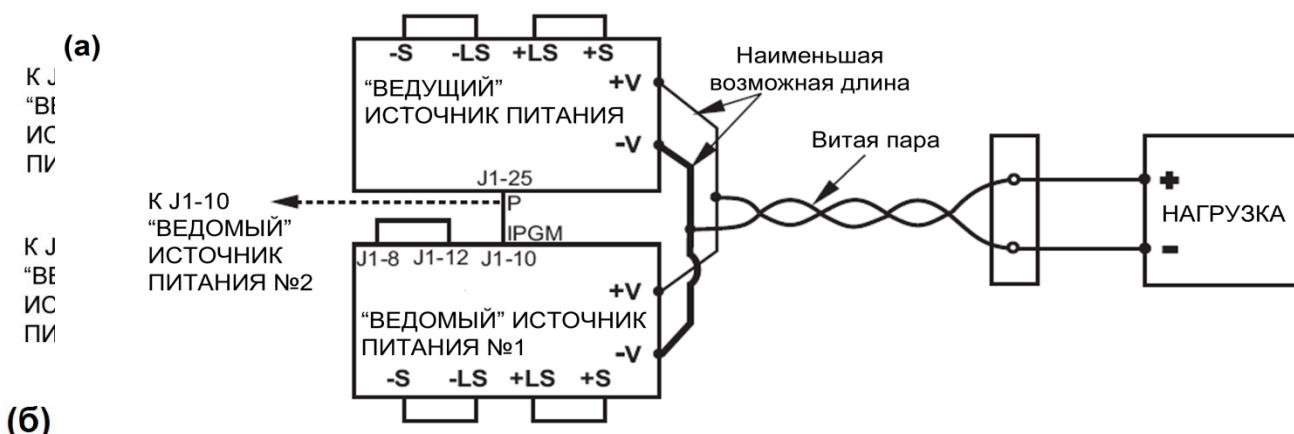
Рис.5-4: Параллельное соединение в режиме внутреннего контроля: а)-для моделей от 7,5 до 600 В; б)-для моделей от 800 до 1500 В
