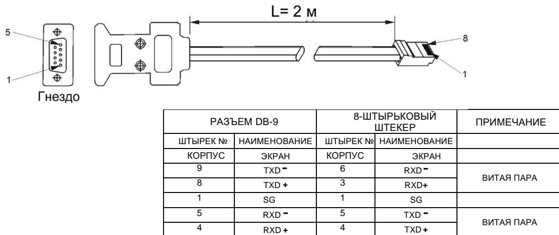
Рис.7-4: Кабель RS485 с соединителем DB9 (P/N: GEN/485-9)
