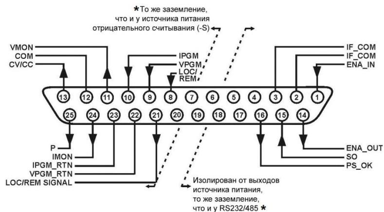
Рис.4-4: Соединительные разъемы J1 и их функции
