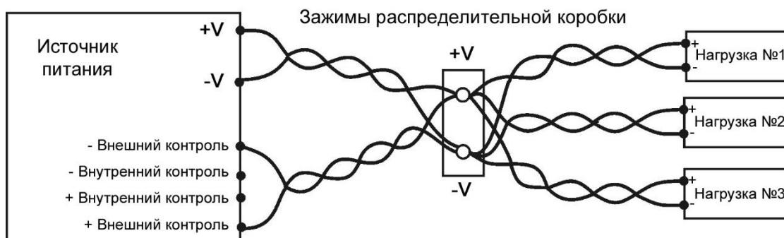
Рис.3-8: Подсоединение множественной нагрузки посредством зажимов распределительной коробки
